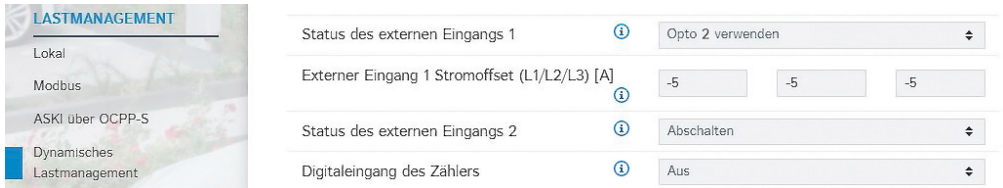
Abb. 39: Weboberfläche des DLM-Masters zur Konfiguration von dem Downgrade-Eingang des gesamten Ladepunktverbunds
