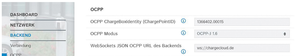
Abb. 18: Weboberfläche von jeder vernetzten Ladestation zur Konfiguration des OCPP Kommunikationsprotokolls
